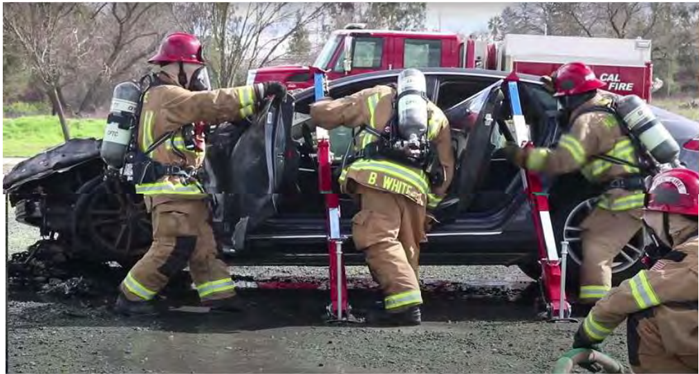
Figure 7 : levage d'un véhicule Tesla pour combattre l'incendie (Source : slides envoyés par Tesla)
