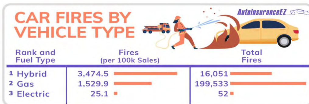
Figure 13 : Nombre de départs de feu aux États-Unis en 2020 pour des véhicules électriques, hybrides ou thermiques en valeur absolue et en proportion du nombre de véhicules de chaque catégorie vendus. Source AutoinsuranceEZ 167
